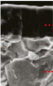
PVD-beschichtete Sorte für einen breiten Anwendungsbereich. Die Kombination aus einem speziellen Hartmetallsubstrat und der MIRACLE-Beschichtung bewirkt ein ausgezeichnetes Verhältnis zwischen Verschleiß- und Bruchfestigkeit.
