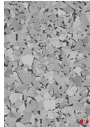
Hartmetallsorte mit einer höheren Härte als RT9020, welche sich ideal für lange Standzeiten in stabilen Anwendungen eignet.
