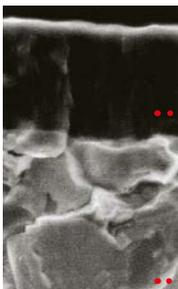
Eine Kombination aus einem speziellen, zähen Hartmetallsubstrat und der MIRACLE-Beschichtung. Ideal für den Einsatz im unterbrochenen Schnitt von rostfreiem und allgemeinem Stahl.
