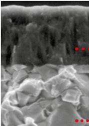
PVD-beschichtete Sorte mit einem Hartmetallsubstrat, das härter als VP20RT ist. Einsetzbar bei schwer zu bearbeitenden Werkstoffen und Erreichung einer längeren Werkzeugstandzeit.
