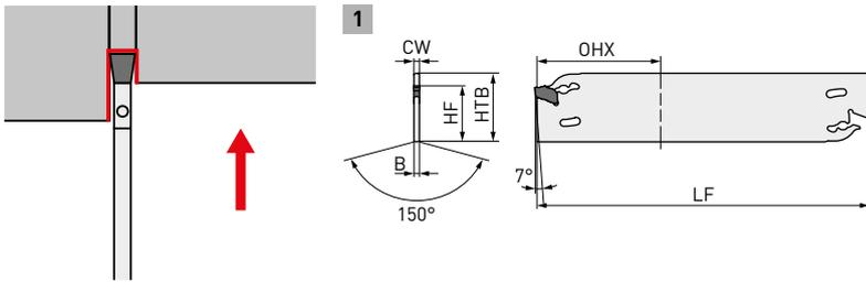
Einfaches Klemmen der Schneidplatte und hohe Steifigkeit.
