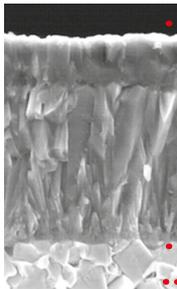
CVD-beschichtete Sorte mit ausgezeichnetem Verschleißwiderstand auch bei hohen Temperaturen. Längere Werkzeugstandzeit bei der Bearbeitung von Gusseisen und duktilem Gusseisen. Auch für die Hochgeschwindigkeitsbearbeitung im Stahlbereich geeignet.
